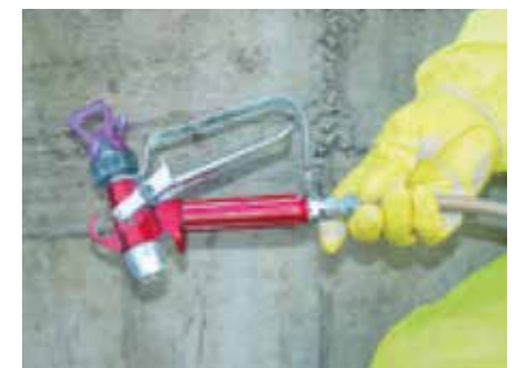
Leicht zu reinigende Wendedüse für alle Airlessgeräte
