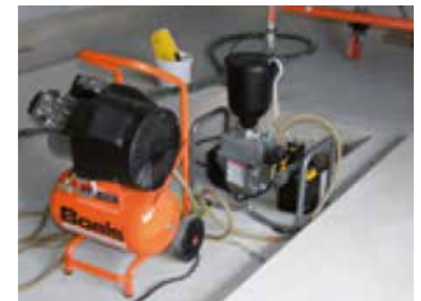
Membran-Airlessgerät mit Kompressorantrieb
