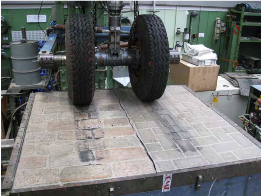
Bild 1: Situation im Überrollversuchsstand: linke Seite Natursteinpflaster, rechte Seite Betonsteinpflaster.
