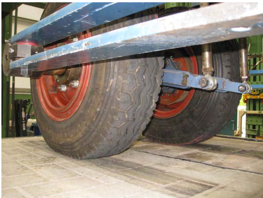
Bild 2: Überrollung der Teilflächen parallel zur Trennfuge.
