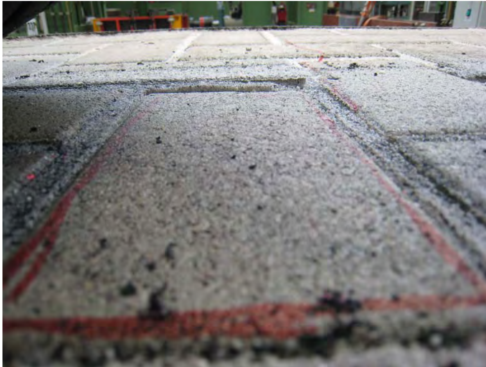
Bild 7: Abschluss der Phase 4; einzelne Steine wurden mehrere Millimeter eingedrückt.
