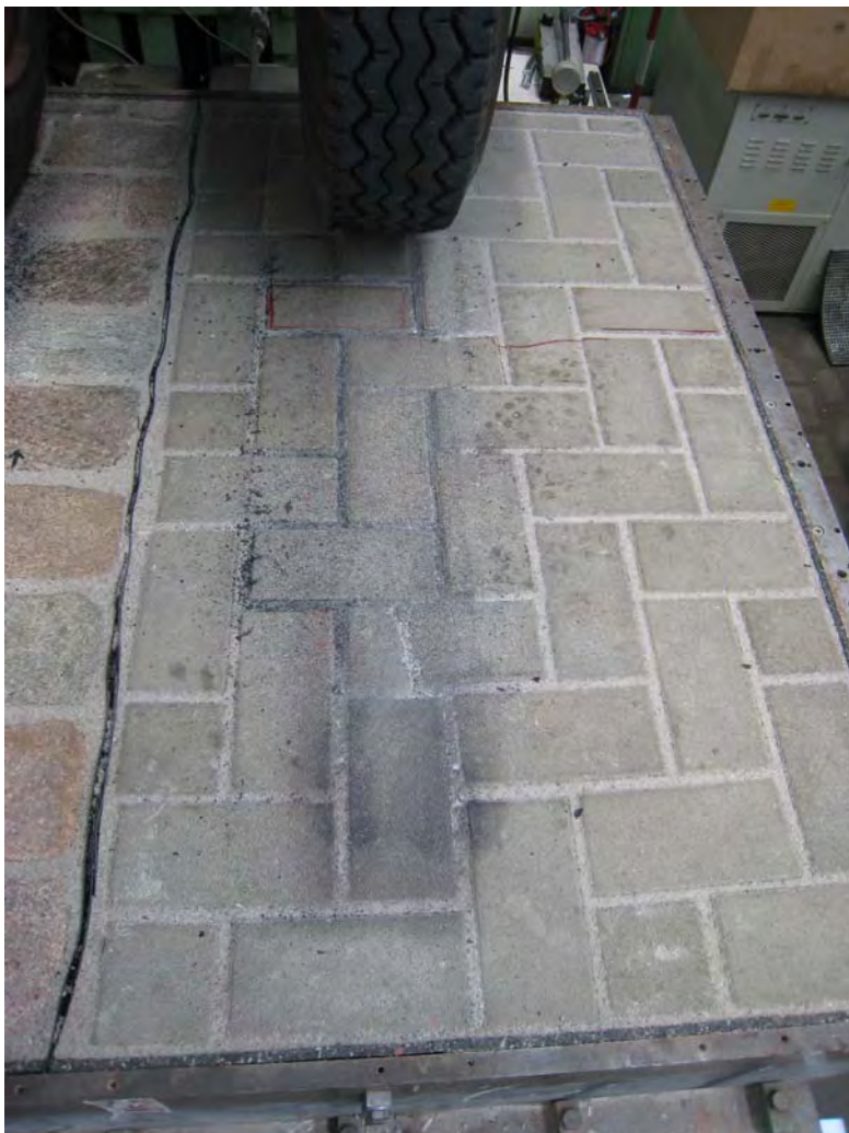
Bild 5: Bildung weiterer Längs- und Querrisse, Lockerung einzelner Steine während weiterer Überrollungen, Bruch weiterer Steine in der Versuchsphase 4.
